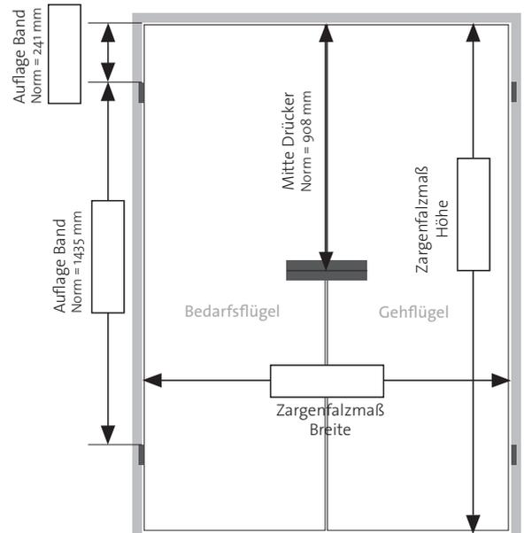
\*Griffwerk berechnet das Glasmaß wie folgt: Breite: - 3,5 mm links, - 4 mm mitte, - 3,5 mm rechts, Höhe: - 4 mm oben, - 7 mm unten
