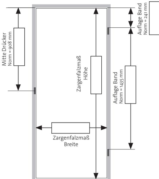
\*Griffwerk berechnet das Glasmaß wie folgt: Breite: - 3,5 mm links, - 3,5 mm rechts, Höhe: - 4 mm oben, - 7 mm unten
