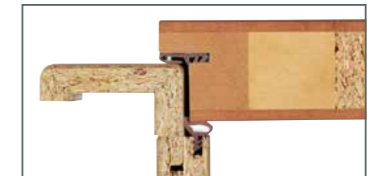
Zwei Dichtungsebenen durch die integrierte Türfalz-Dichtung und die akustisch wirksame Zargendichtung.
