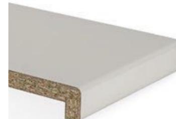
Fensterbank aus einer quellarmen Holzspanplatte Typ P3 nach EN 312, verklebt mit robustem Duopal HPL nach EN 438. Die Postforming-Längskante besitzt einen Radius von 3 mm und ist mit einer Abkantung versehen. Die 38 mm Abkantung setzt optische Akzente. Es lassen sich so elegant Vorsprünge abdecken oder Heizkörperverkleidungen ansetzen.
