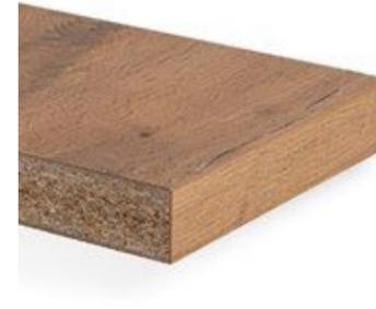
Arbeitsplatte aus einer Holzspanplatte nach EN 312, Dekorseite verklebt mit robustem Duropol HPL nach EN 438, Unterseite mit wasserabweisendem Gegenzug. Die vordere Längskante der Arbeitsplatte PerForm ist mit einer Laserkante versehen, die Hinterkante ist mit einer Schutzkante versiegelt. Als Variante ist sie auch beidseitig mit Laserkante erhältlich.
