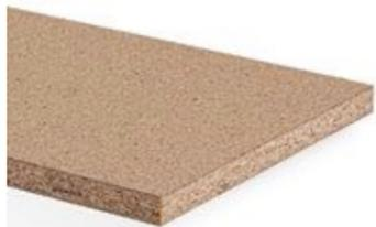
Holzspanplatte Typ P5 gemäß DIN EN 312, für tragende Zwecke zur Verwendung im Feuchtbereich, unbeschichtet und 100 % formaldehydfrei verleimt.
