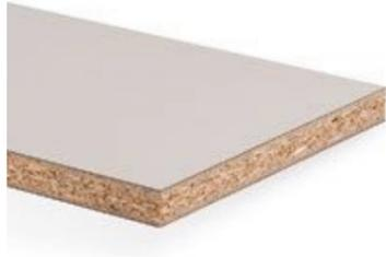
Verbundelement aus einer Holzspanplatte Typ P2 nach EN 312, beidseitig belegt mit Duopal HPL. Mit diesem Plattenwerkstoff werden aufgrund des absolut minimierten Formaldehydgehalts die Grenzwerte des EPF- sowie des CARB2-Standards problemlos eingehalten.
