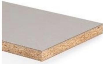
Verbundelement mit authentischer Echtmetalloberfläche aus einer Holzspanplatte Typ P2 nach EN 312, beidseitig belegt mit Duropal HPL Echtmetall.
