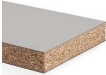
Arbeitsplatte aus einer Holzspanplatte nach EN 312, Dekorseite verklebt mit robustem Duropol HPL nach EN 438, Unterseite mit wasserabweisendem Gegenzug. Die Längskanten der Arbeitsplatte sind gefräst.
