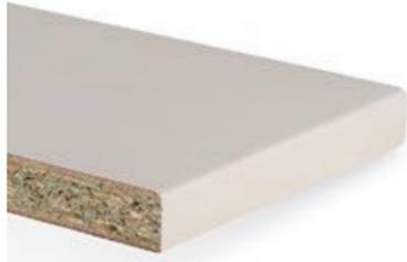
Möbelement aus einer quellarmen Holzspanplatte Typ P3 nach EN 312, verklebt mit robustem Duopal HPL nach EN 438. Die Postforming-Längskante besitzt sowohl an Ober- als auch Unterseite einen Radius von 3 mm, wodurch das Möbelement universell als Möbelement, Fensterbank oder dünne Arbeitsplatte einzusetzen ist.
