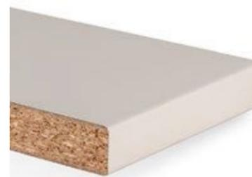
Arbeitsplatte aus einer Holzspanplatte nach EN 312, Dekorseite verklebt mit robustem Duopal HPL nach EN 438, Unterseite mit wasserabweisendem Gegenzug. Die Postforming-Vorderkante der Arbeitsplatte Quadra besitzt einen Radius von 3 mm, die Hinterkante ist mit einer Schutzkante versiegelt. Als Variante ist sie auch beidseitig profiliert erhältlich.
