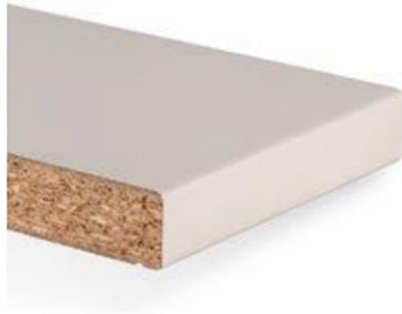
Arbeitsplatte aus einer Holzspanplatte nach EN 312, Dekorseite verklebt mit robustem Duropol HPL nach EN 438, Unterseite mit wasserabweisendem Gegenzug. Die Postforming-Vorderkante der Arbeitsplatte Cubix besitzt einen Radius von 2 mm, die Hinterkante ist mit einer Schutzkante versiegelt. Als Variante ist sie auch beidseitig profiliert erhältlich.
