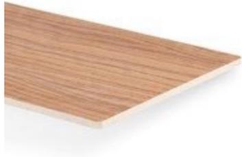
Brandschutzplatte der IMO-Einstufung „Low Flame-Spread Surface Material“ aus primär mineralischen Bestandteilen mit homogen weiß gefärbtem Kern und beidseitig dekorativer Melaminharzoberfläche.
