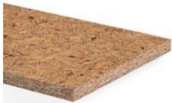
Holzspanplatte Typ P7 gemäß DIN EN 312, hoch belastbar, für tragende Zwecke zur Verwendung im Feuchtbereich, unbeschichtet und 100 % formaldehydfrei verleimt.
