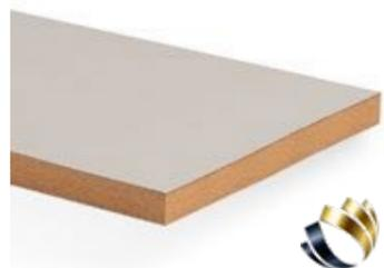
Melaminbeschichtete mitteldichte Faserplatte mit hochwertiger und innovativer Mehrschicht-Lackierung, bestehend aus einer dauerelastischen Funktionsschicht und UV-härtenden Acryllacken.
