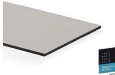
Compact Hochdruckschichtstoff für die Außenanwendung in flammhemmender Qualität gemäß EN 438-6:EDF / Intensiv-Dekore gemäß EN 438-6:EGF. Mit homogen schwarz gefärbtem Kern und einseitiger dekorativer Acryllack-Lackierung auf der Oberseite und rückseitiger dekorativer Melaminharzoberfläche.
