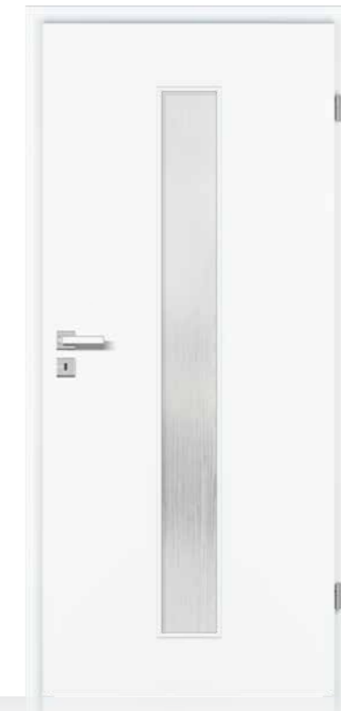
3 MODELL: TB-PK-LA2, CPL WEISSLACK 9016 ZARGE: FU-RF-KR, 60/16 MM GLAS: LIGNO, Ornamentglas BESCHLAG: QUADRAL-Inlay, Flachrosette inkl. Schloss-Rosette MODÈLE: TB-PK-LA2, CPL BLANC LAQUÉ 9016 CHÂSSIS: FU-RF-KR, 60/16 MM VERRE: LIGNO, Verre décoré FERRURE: QUADRAL-Inlay, Rosette plate avec serrure et rosette
