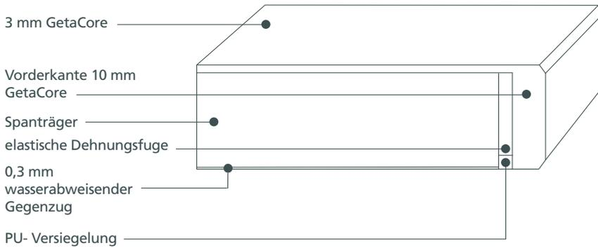
35 mm Qualitätsspanplattenträger Typ P3 nach DIN EN 312, Oberseite mit 3 mm Acryl-Mineralwerkstoff GetaCore belegt, nass geschliffen (P 600). Unterseite 0,3 mm Gegenzug, Vorderkante GetaCore 10 mm mit Dehnungsfuge. Stoßstelle GetaCore/ Gegenzug feuchtebeständig versiegelt. Oberfläche mit Folie geschützt.
