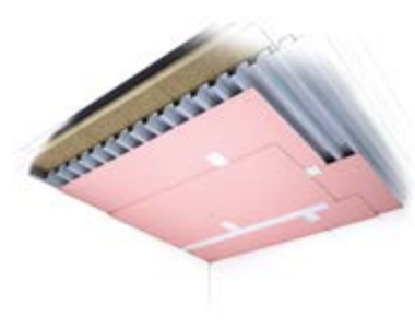
Bekleidung von Trapezblechdächern Brandschutz bis 90 Minuten Feuerwiderstand
