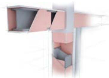
Stahlstützen- & Stahlträgerbeklei- dungen, 4-seitig / Brandschutz bis 180 Minuten Feuerwiderstand
