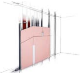
Schachtwände Brandschutz bis 90 Minuten Feuerwiderstand
